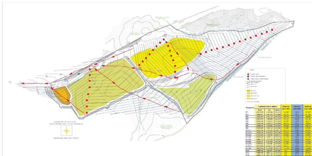
Figura 32: Planimetria con ubicazione dei piezometri di controllo (aggiornata con i nuovi piezometri al 2021)
